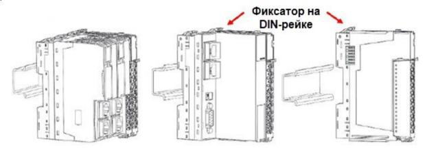
2) Разблокируйте «Фиксатор на DIN-рейке» как показано под цифрой (1).
